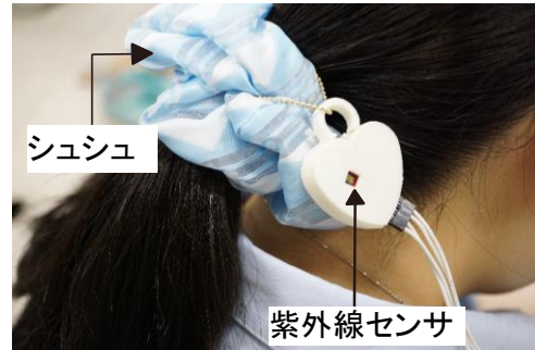
図3.紫外線センサを組み込んだチャーム
