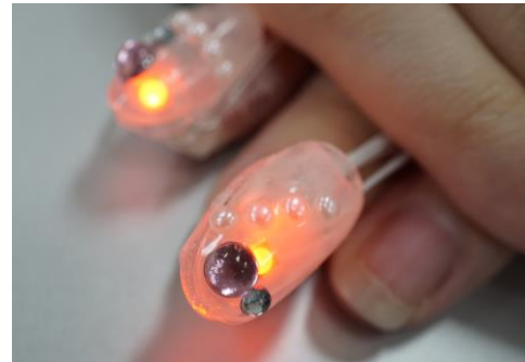
図4.付け爪型ウェアラブル端末の実装
