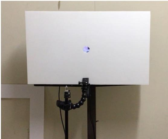
図2: モニター前に目隠しを設置したプロトタイプ
