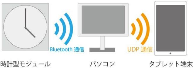
図9.時計型デバイスとコンテンツ端末の通信
