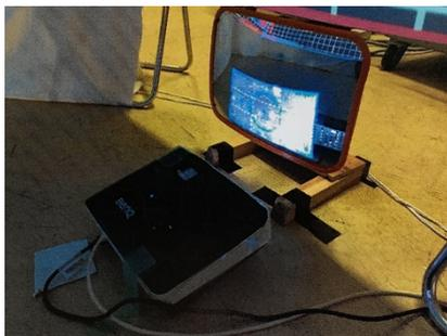
図2 プロジェクターとカーブミラーを使用した投影<sup>[2]</sup>
