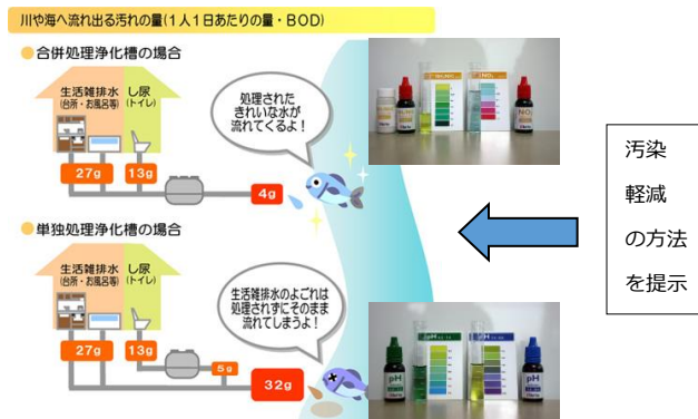
図1 合併処理浄化槽と単独処理浄化槽の違い(4)
